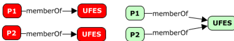
Figura 15 – Exemplo da representação de duas triplas da forma feita pelo grafo resultante do mapeamento (esquerda – vermelho) e da forma como deveria ser (direita – verde)
